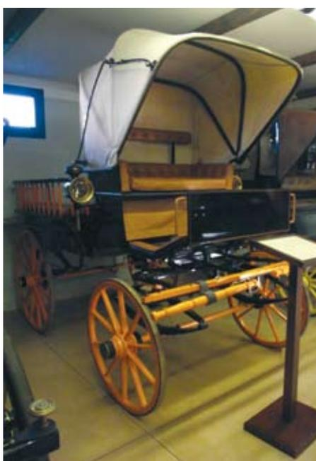
creando il cosiddetto collo di cigno, un rialzo del bordo chiamato codone, che permise alla ruota di girare. Un'altra caratteristica che differenzia il carro dalla carrozza è il molleggio perché mentre sul carro la cassa poggia direttamente sull'asse delle ruote, nella carrozza il movimento viene attutito da molle ellittiche.
